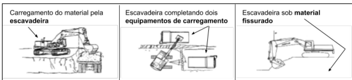
Figura 57 Esquema da remoção mecânica de material (adaptado de Cardu & Giraldi, 2009)
