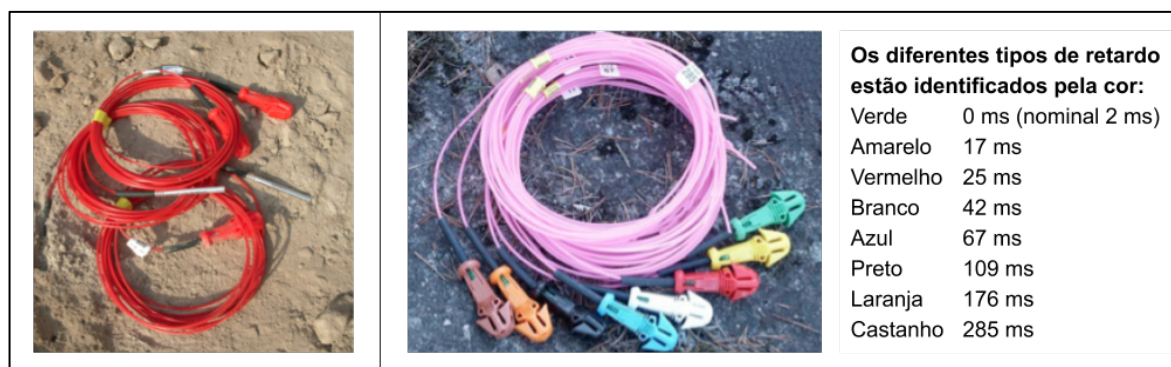
Figura 29 À esquerda: detonador não-elétrico de longo período de 500 ms; à direita: conectores com diferentes retardos (adaptado de catálogo “Dyna Nobel”, 2016)
